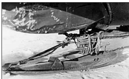
Reparación de emergencia de un esquí del TA-05, durante el vuelo al Polo Sur (1965)
