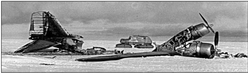
Restos del C-47 TA-33. Tras el incendio, al intentar despegar de la Base Ellsworth con destino al Polo Sur (10 de diciembre de 1962)
