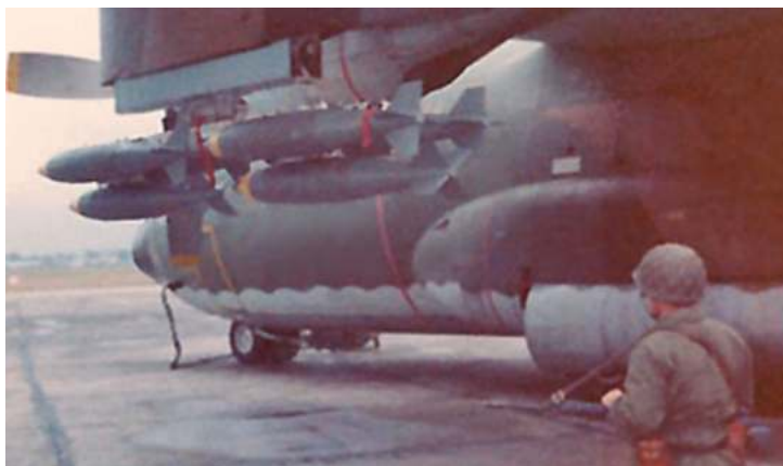
El TC-68 cargado con doce bombas BR-250, seis en cada plano, y cada una con dos espoletas de 12 segundos – Gentileza: Com. VGM (R) Dávila
