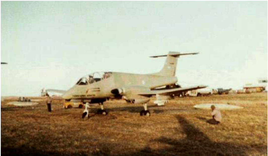
Pucará en la BAM Cóndor se apresta a rodar para el despegue; obsérvese la profundidad de las ruedas debido al terreno blando y esponjoso – BANIM DEH-FAA
