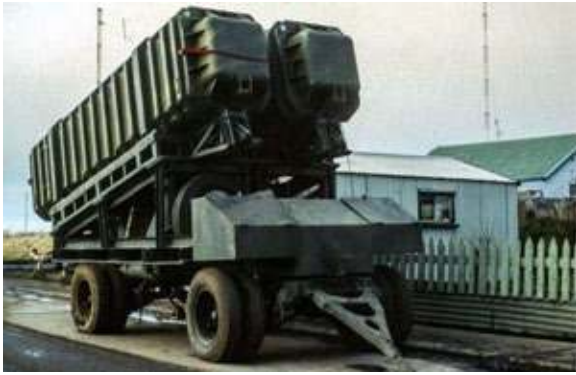
Lanzador del Exocet MM-38 montado sobre un remolque desde donde sería disparado hacia el HMS Glamorgan BANIM DEH-FAA
