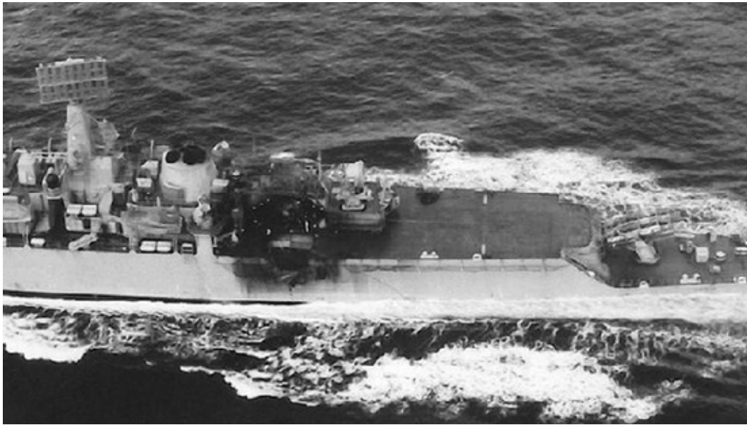
Daños provocados en el destructor HMS Glamorgan por el misil Exocet MM-38 lanzado desde la costa - BANIM DEH-FAA
